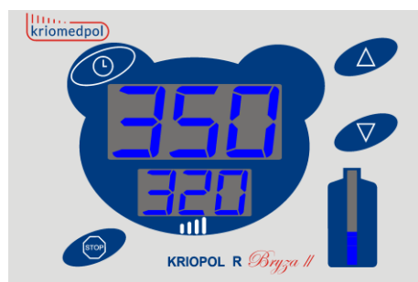
Rys. 5 Korekta ustawienia wskazania dolnego (wartość aktualna 350, wartość zapamiętana 320).
