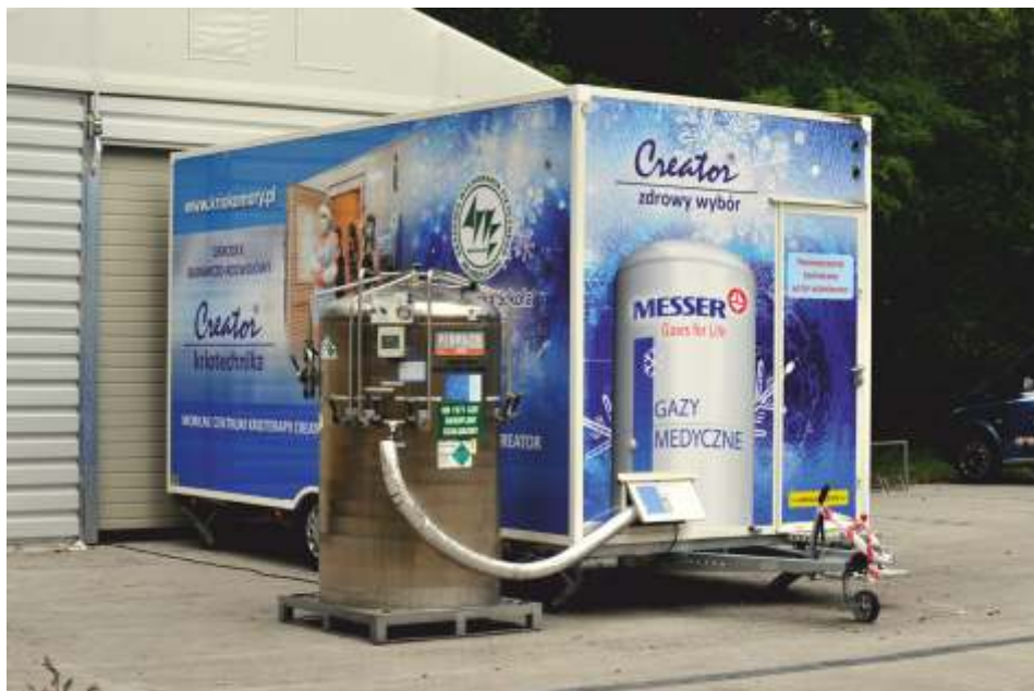
Fot. 4. Model kriokomory mobilnej wbudowanej w naczep samochodów (zasilanie ze zbiornika)
