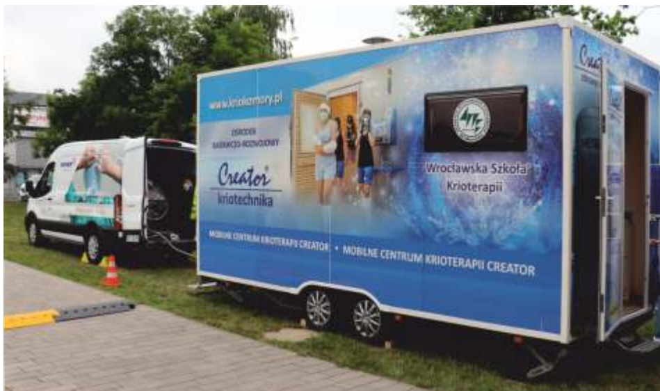
Fot. 5. Model kriokomory mobilnej wbudowanej w naczep samochodów (zasilanie ze specjalistycznego samochodu cysterny)
